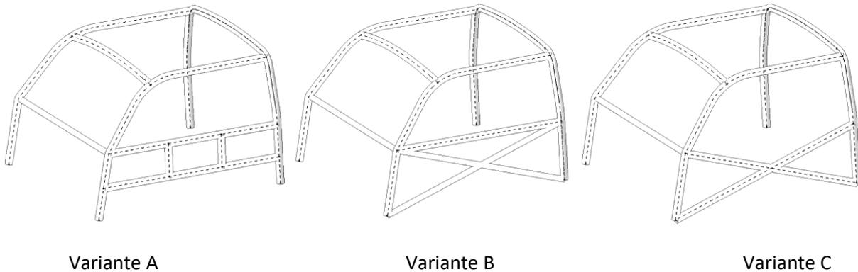
Alle hier gezeigten Varianten und Rohrdurchmesser sind lediglich Mindestanforderungen, deren Sicherheit jederzeit durch weitere Rohre oder andere Durchmesser verbessert werden kann.
